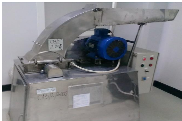
Fig.3. Moara pentru maruntit planta Tip Remeco
